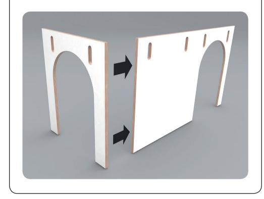
2. Das zweite lange Seitenteil auf die andere Seite des kurzen Seitenteils aufstecken und mit dem Inbus festziehen.
